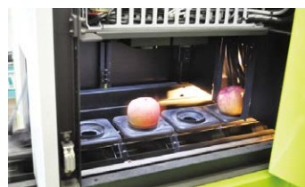
透過型下抜きセンサーで内部を確認
