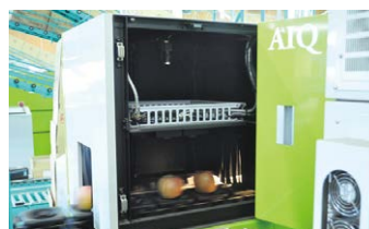
CCDカメラで外観を確認
