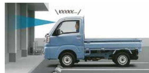
駐車場でペダルを踏み間違えた時、急発進を抑制 誤発信抑制制御機能(前方) 約10km/hで障害物を認識後、踏み間違い(アクセルペダルを強く踏み込んだ場合)を判定してエンジン出力を抑制し、ブザー音とメーター内表示でお知らせします。
